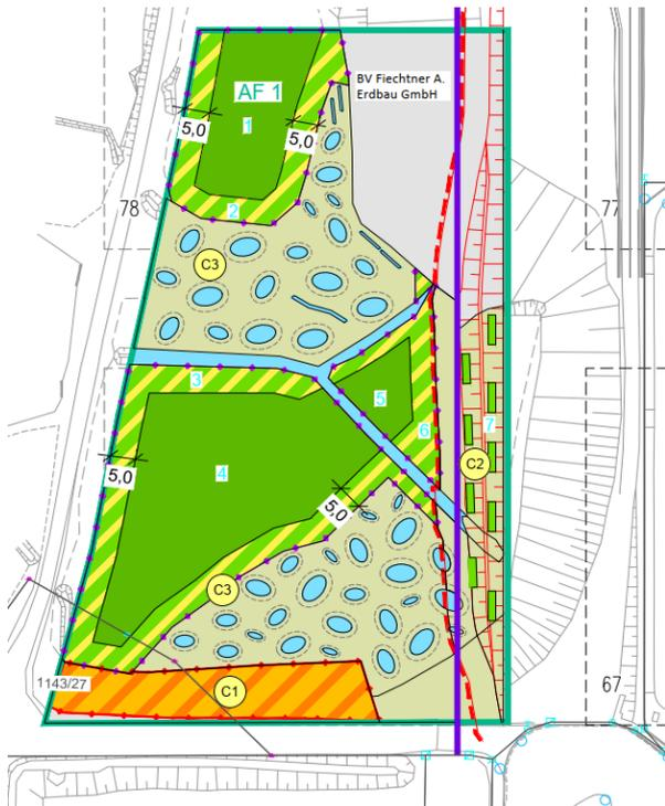
Abbildung 3: Konkretisierte Ausführungsplanung (Übersicht). Die anzulegenden Kleingewässer sind in hellblau dargestellt, einschl. einer Umringung (---- gestrichelt) für den Umfang der notwendigen Geländeabgrabung.
